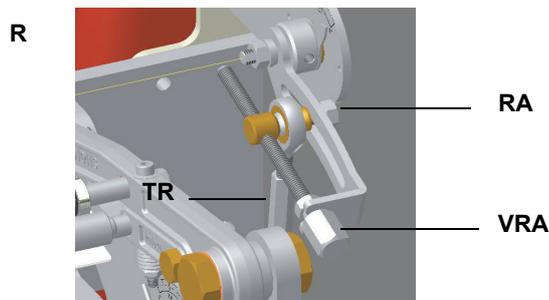
13 Se necessario, regolare la posizione della testa di combustione (vedi relativo paragrafo).
