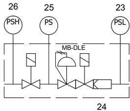
A seconda del tipo di bruciatore e della dimensione della rampa gas, le valvole MB-DLE sono fornite al posto delle VGD. In questo caso, l'elemento 42 è incluso ne gruppo valvole. Vedi lo schema seguente.
