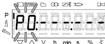
Premere "F" e "+" per aumentare l'angolo di apertura del servocomando combustibile "0F" fino al valore desiderato (per esempio 12° ÷ 15° -vedi sotto) per il punto di accensione oppure "F" e "-" per diminuire l'angolo:
