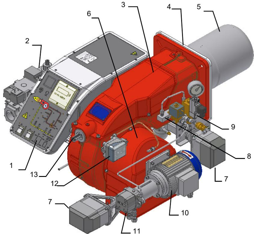
**Funzionamento a gas:** il gas, proveniente dalla rete di distribuzione, passa attraverso il gruppo valvole, complete di filtro e stabilizzatore. Quest'ultimo mantiene la pressione nei limiti di utilizzo. I servocomandi, agiscono modo proporzionale sulle serrande di regolazione della portata dell'aria comburente e sulla valvola a farfalla del gas, consentendo di ottimizzare i valori del gas di scarico e, quindi, di ottenere un'efficace combustione.
