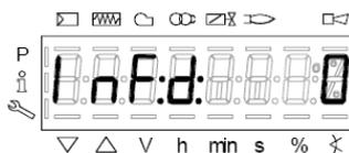
Для того, чтобы выполнить сброс блокировки, нажать кнопку **InFo** на одну секунду. Зарегистрировать номера и проверить в таблице ошибок тип аварийного случая.
