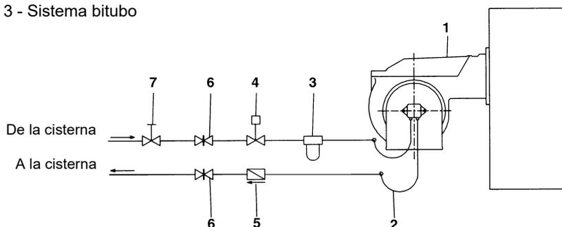
El suministro preve el filtro y los flexibles, toda la parte ante del filtro y la parte despues del latiguillo de retorno, tiene que ser predispueta por el usuario. Por la conexion de los flexibles, consultar el relativo párrafo.
