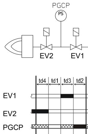
Si todas las fases antes enumeradas son realizadas con éxito, la prueba de estanqueidad puede considerarse concluida de forma positiva. De lo contrario, se producirá un bloqueo del quemador. Para LMV5x, LMV2x/3x y LME73 (excepto para LME73.831BC), el control de estanqueidad puede ser configurado de modo que se produzca en el encendido, apagado o ambos.
