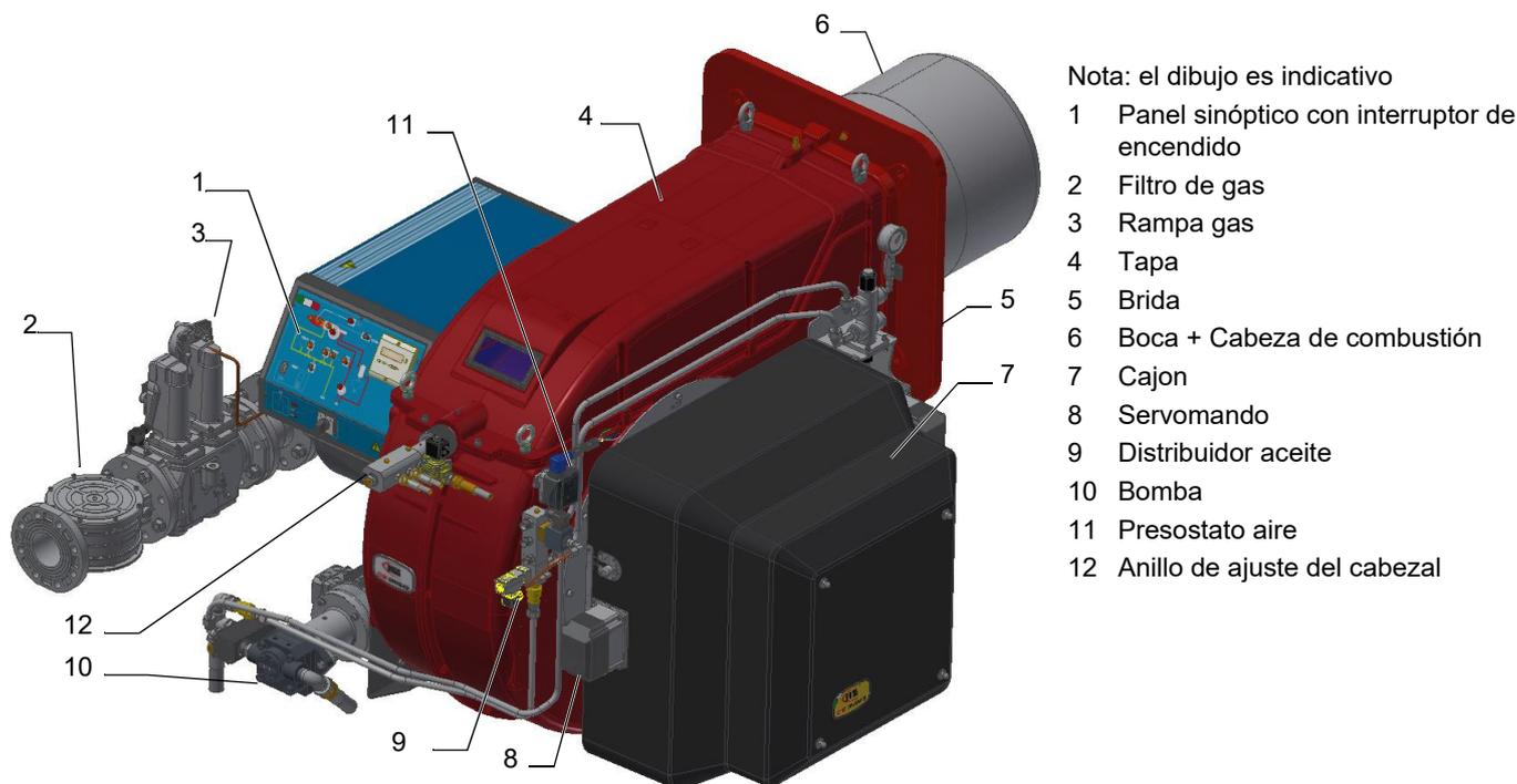
**Funcionamiento con gas:** el gas que proviene de la red de distribución pasa a través del grupo de válvulas que cuentan con filtro y estabilizador. Este último mantiene la presión dentro de los límites de uso. El servomando eléctrico que actúa de manera proporcional en los registros de regulación del caudal de aire comburente y en la válvula de mariposa de gas, permite optimizar los valores del gas de descarga y, por tanto, obtener una combustión eficaz.
