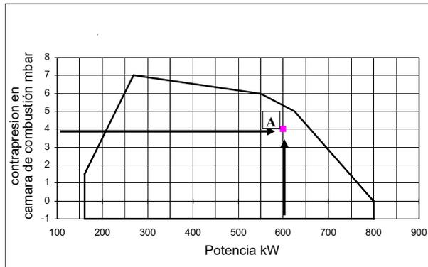
Trazar, en el diagrama "Campo de trabajo" del quemador una rectal vertical en correspondencia con la potencia del fuego y una recta horizontal en correspondencia con el valor de presión que interesa.
