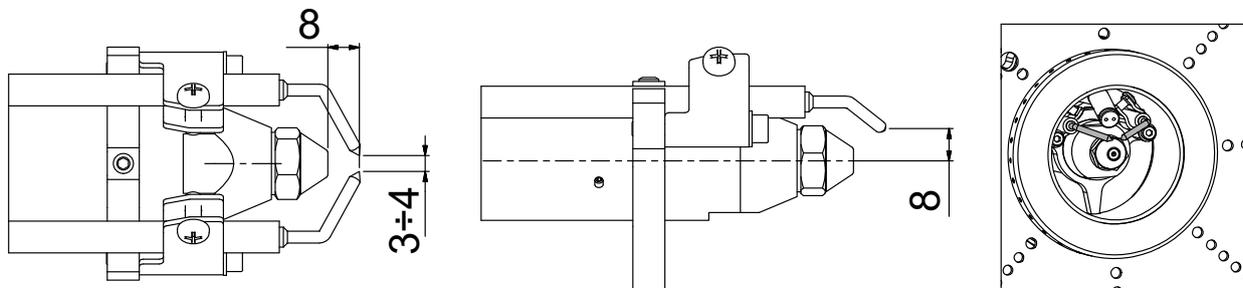
**Limpeza/sustitución de los electrodos**
