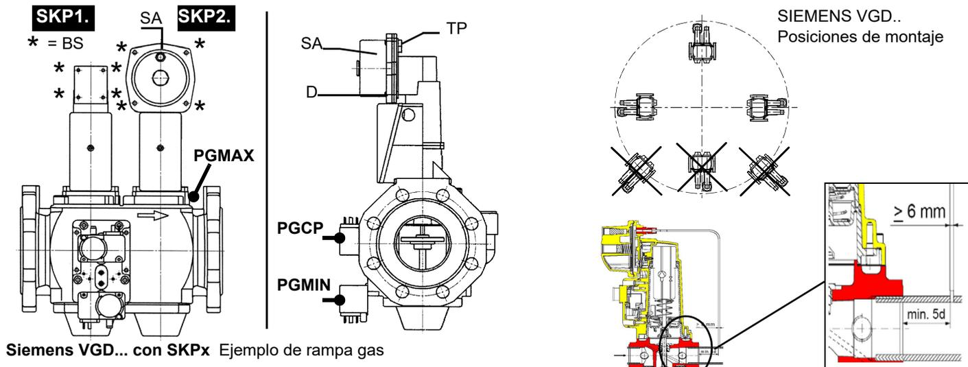
Siemens VGD... con SKPx Ejemplo de rampa gas
